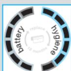
El indicador de carga de la afeitadora ⑯ muestra el nivel de carga de la batería del lado izquierdo y el estado de limpieza del lado derecho. (Se muestran 6 segmentos oscuros de cada lado cuando la batería está totalmente cargada y la afeitadora está completamente limpia).
