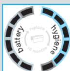
L'afficheur du rasoir ⑯ indique l'état de charge de la pile, à gauche, et l'état d'hygiène, à droite. (Six segments foncés apparaissent de chaque côté lorsque la pile est chargée à pleine capacité et que le rasoir est d'une propreté hygiénique.)
