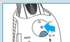
Au cours du processus de nettoyage, la diode du programme de nettoyage sélectionné clignote. Chaque programme de nettoyage comprend plusieurs cycles, au cours desquels le liquide nettoyant s'écoule dans la tête de rasage et un processus de séchage à la chaleur permet de sécher le rasoir. Selon le programme sélectionné, le nettoyage complet dure de 32 à 43 minutes.
