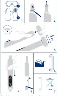
Ouvrir le compartiment à pile situé dans le manche comme indiqué, retirer la pile et la jeter conformément aux règlements locaux.
